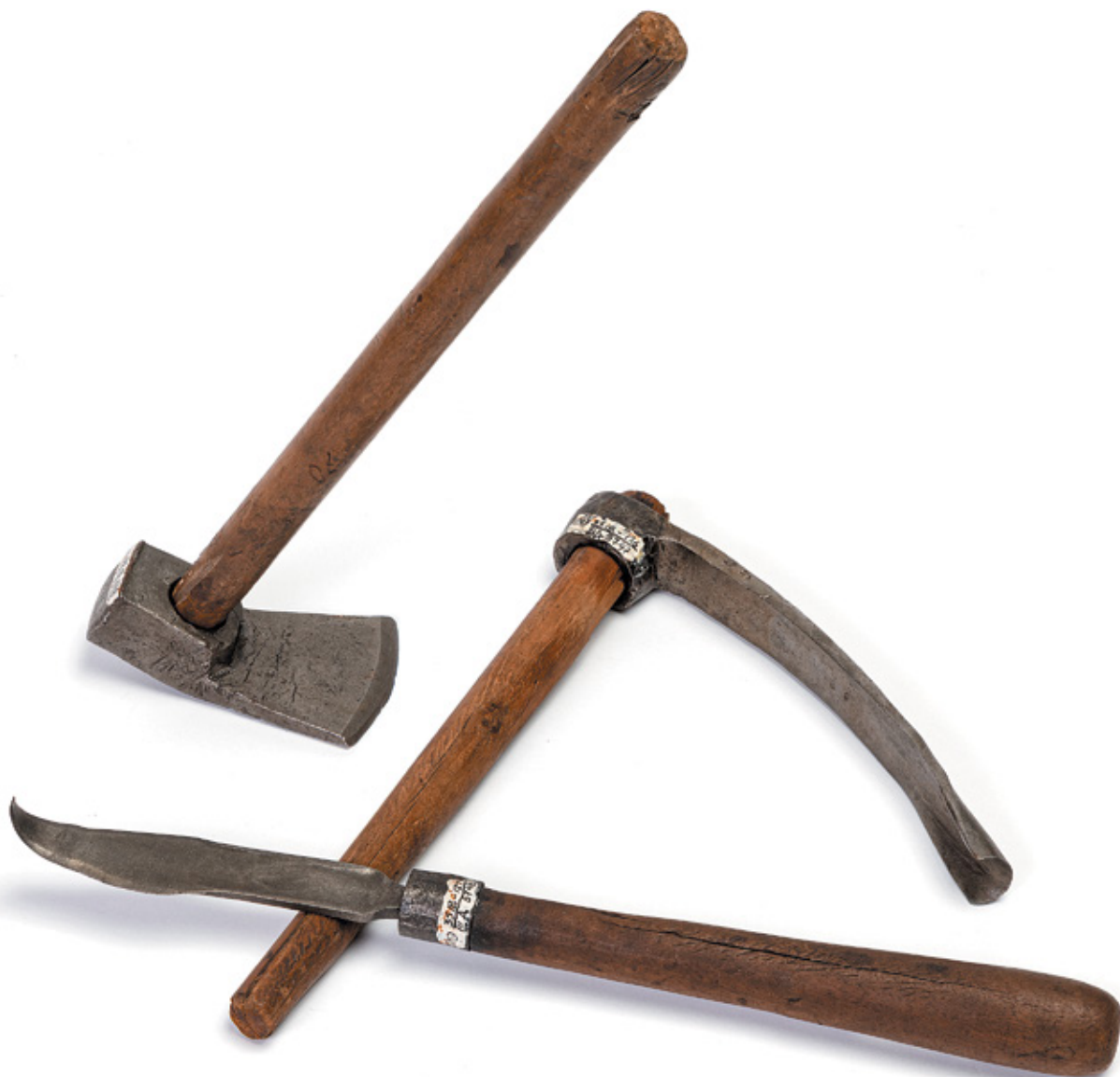
V.1-V.3 Инструменты для тесания и выскабливания кузова музыкального инструмента Елисаветпольская губ., г. Шуши Конец XIX–начало XX в.
