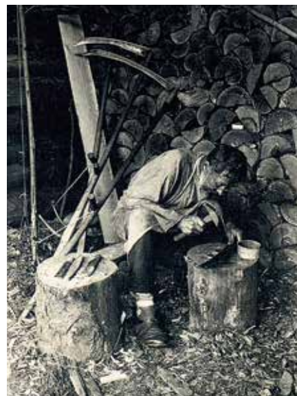
Отбивка косы-литовки. Русские. Ленинградский у., Октябрьская вол., с. Никольское. 1925 г. Фото: А. А. Беликов. МАЭ И-1228-241
