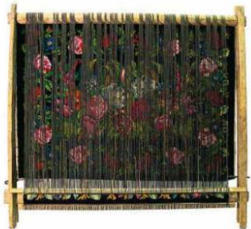
Вертикальный ткацкий станок с натянутой основой на фоне ковра Молдаване. Дондюшанский р-н, с. Марамоновка. XX в. РЭМ 8106-1 а-к; 1204-7
