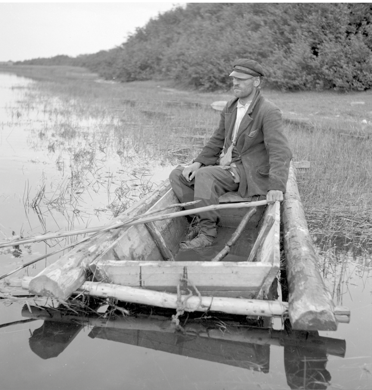
Для передвижения по мелководью использовали канёйку — плоскодонку-ящик. Деревня неизвестна. Фотография Л. Зурова. 1938 г. MQB PF 016917. ■ МнБ
